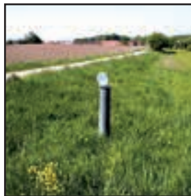
Grundwassermessstelle Volkersdorf 1 Staatliche Umweltbetriebsgesellschaft
