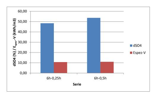
Abbildung 22: Sulfatabtrennung dSO<sub>4</sub> und volumenspezifischer Energiebedarf E<sub>spez</sub>-V
