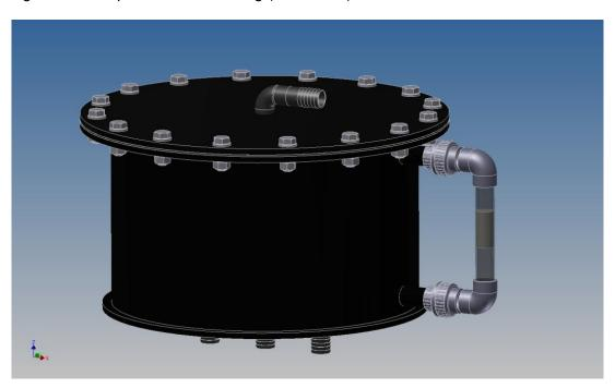
Abbildung 32: Druckausgleichsbehälter für Reaktionsgas
