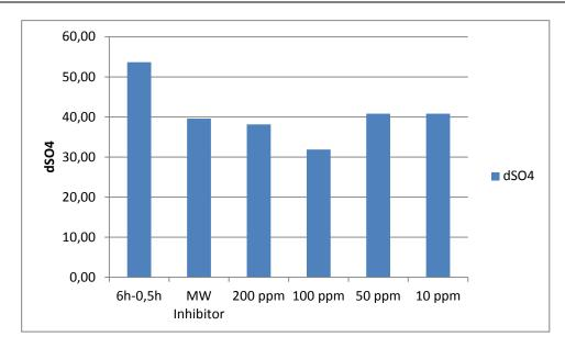
Abbildung 28: Einfluss des Inhibitorenzusatzes auf die Sulfatabtrennung
