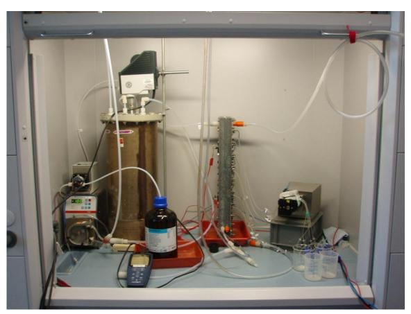
Abbildung 11: Versuchsaufbau mit 500-cm²-Elektrolysezelle Typ VKTA, nicht im Bild: Vorratstank für Tzschellner Wasser, Einspeisung kathodenseitig, Stromversorgung, Datenerfassungssystem
