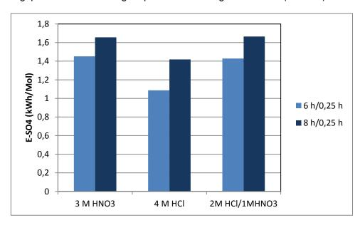
Abbildung 26: Einfluss unterschiedlicher Spülsäuren und Spülintervalle auf den stoffmengenspezifischen Energiebedarf
