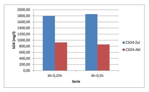
Abbildung 21: Sulfatkonzentration im Zu- und Ablauf der Zelle bei 6 h Spülintervall
