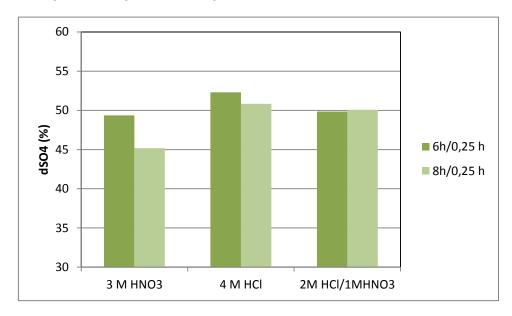
Abbildung 24: Einfluss unterschiedlicher Spülsäuren und Spülintervalle auf die Sulfatabtrennung
