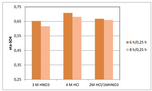
Abbildung 27: Vergleich der Stromausbeuten für die Sulfatabtrennung bei Verwendung unterschiedlicher Spülsäuren und Spülintervalle
