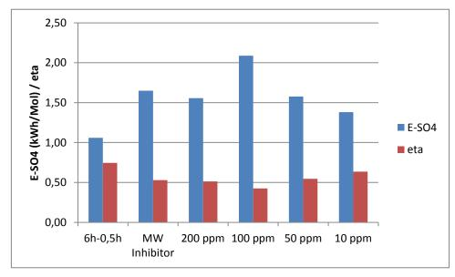
Abbildung 29: Stoffmengenspezischer Energieverbrauch und Stromausbeite mit und ohne Inhibitorenzusatz
