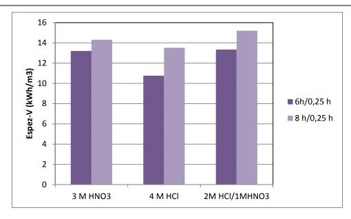
Abbildung 25: Einfluss unterschiedlicher Spülsäuren und Spülintervalle auf den volumenspezifischen Energiebedarf
