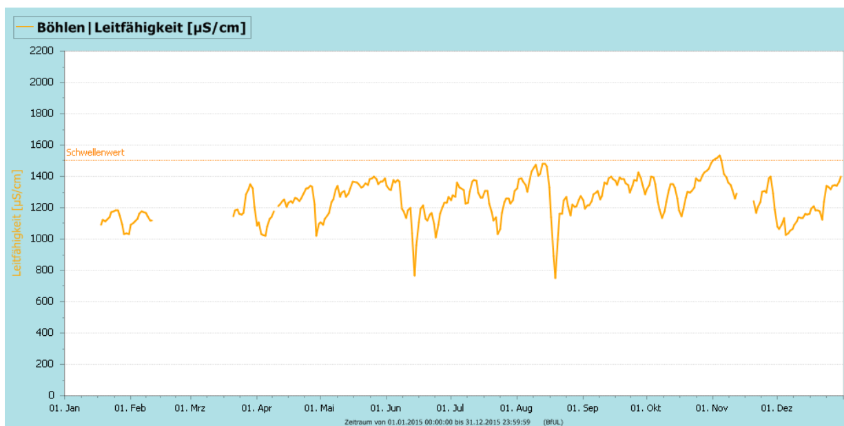
Abb. 15: Tagesmittelwerte elektrische Leitfähigkeit der Messstation Böhlen 2015
