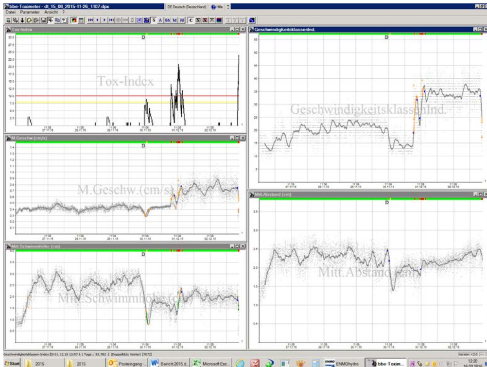
Abb. 23: DaphTox-Alarm vom 01.12.2015, grafische Darstellung der auffälligen Verhaltensparameter
