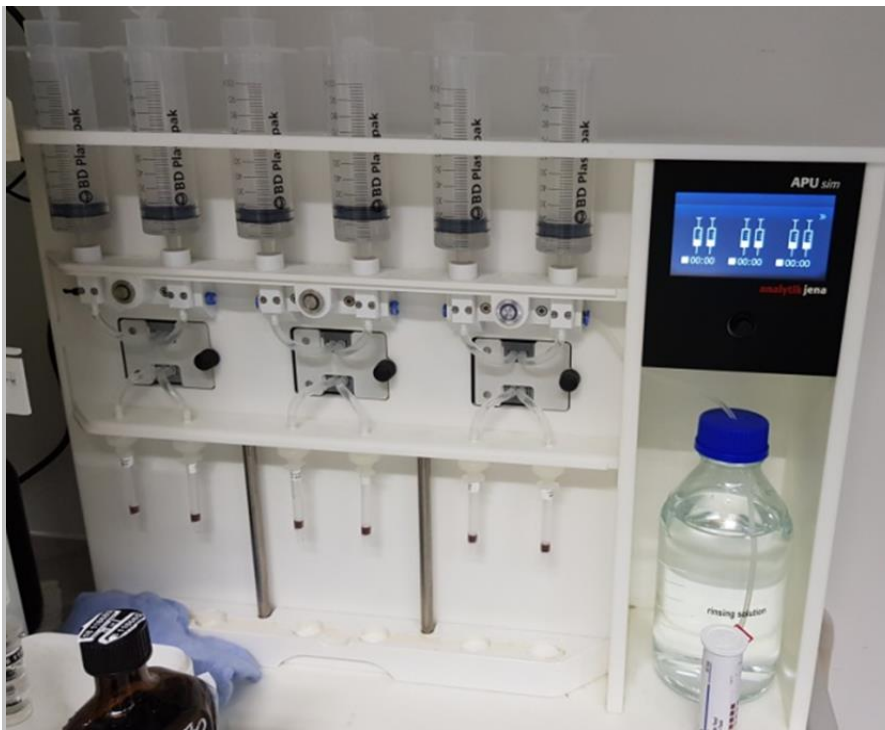
Abbildung 4: Anreicherung der Probe an Aktivkohle für AOF-Analyse
