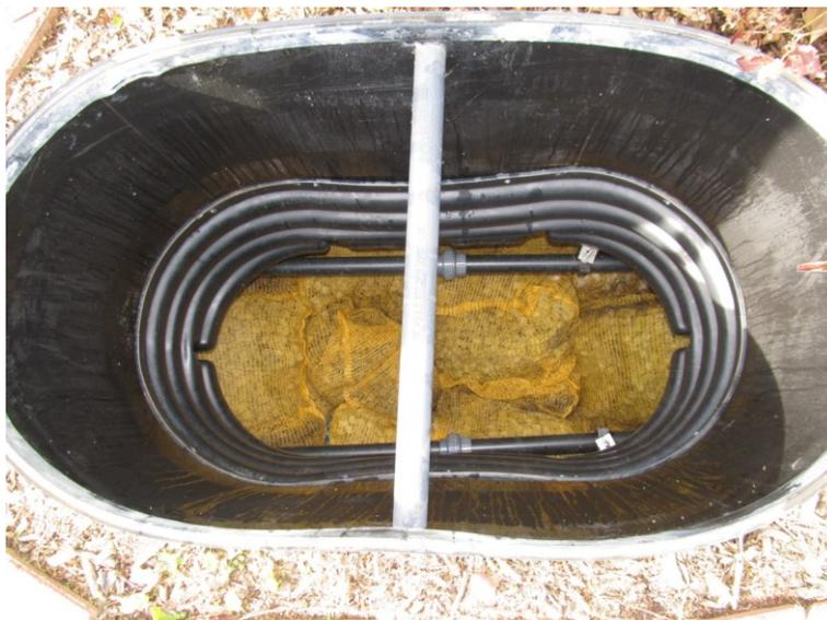
**Abbildung 6-40: Schachtverlängerung mit sichtbarer Verformung**
