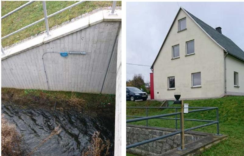
Abb. 3: Wasserstandssensor in Markneukirchen / Vogtland am Schwarzbach (links), Niederschlagsmesser in Luchau / Osterzgebirge (rechts)
