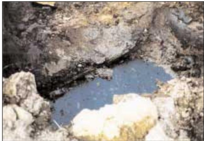
Abb. 5.8: Benzin-Wassergemisch mit aufsitzender Teerphase unter einem ausgebauten Tank
