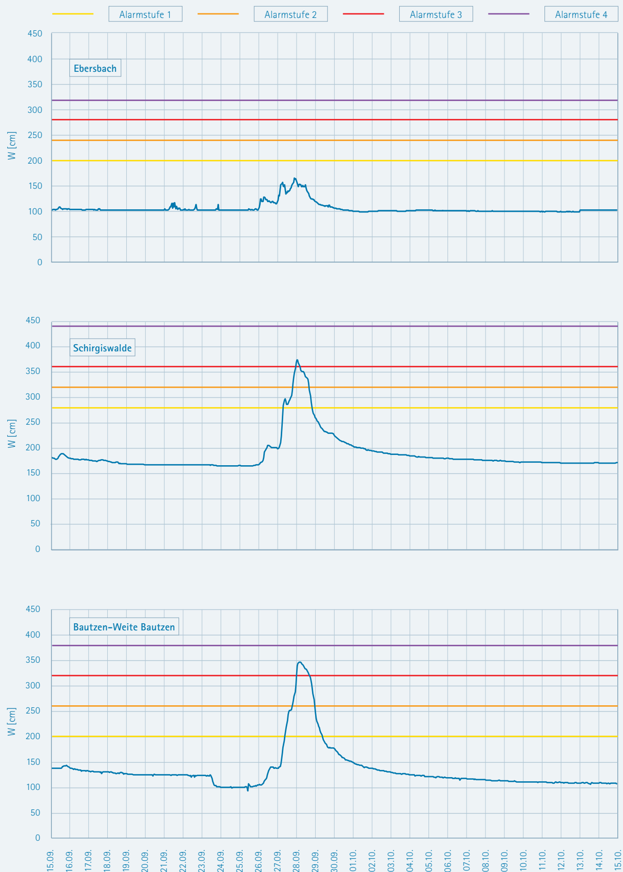
Abbildung 4-54: Beobachtete Wasserstandsganglinien mit entsprechenden Richtwerten der Alarmstufen 1-4 an ausgewählten Pegeln an der Spree für den Zeitraum 15.09.-15.10.2010
