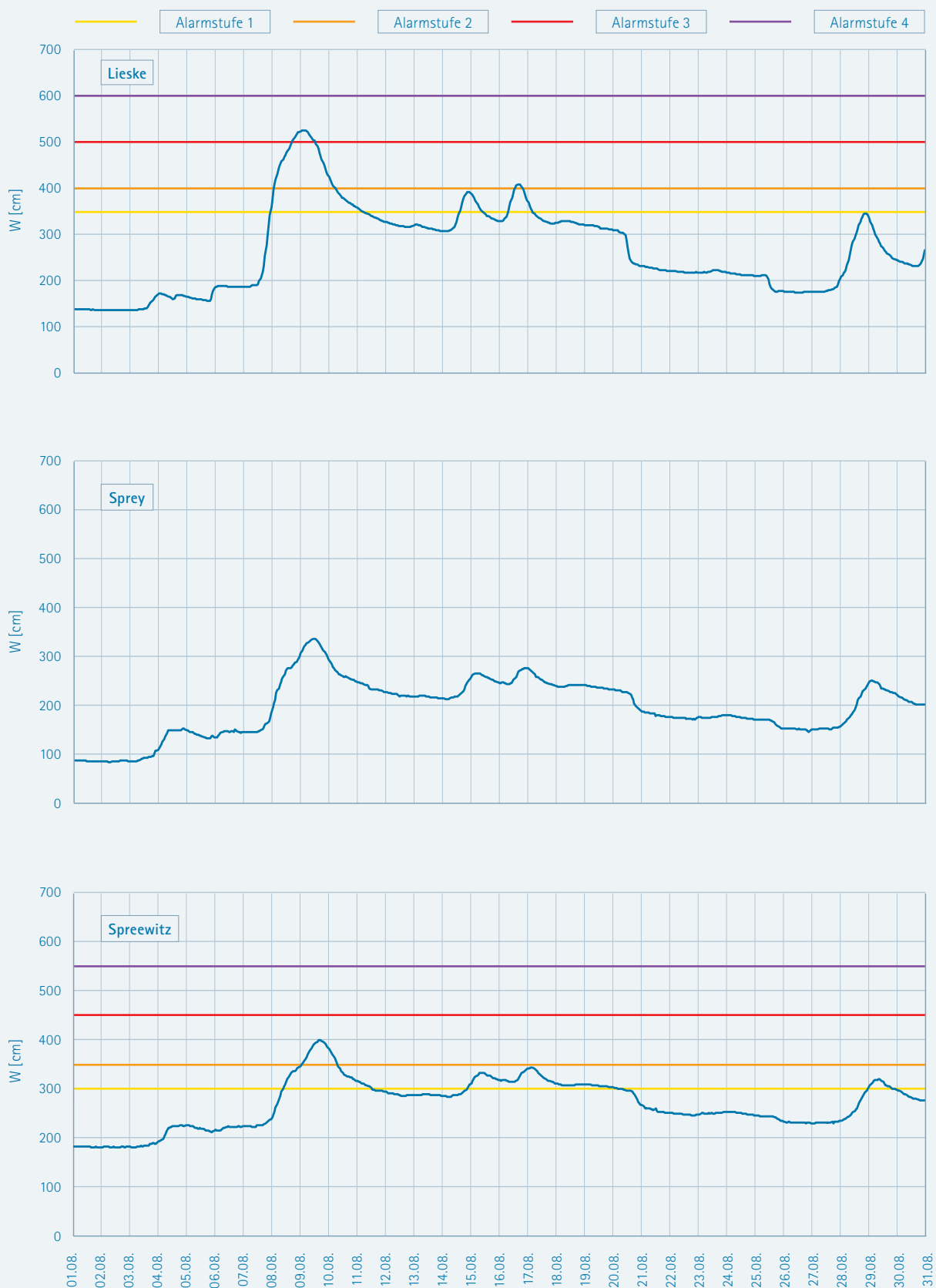
Abbildung 4-53: Beobachtete Wasserstandganglinien mit entsprechenden Richtwerten der Alarmstufen 1-4 an den Pegeln der Spree unterhalb der Talsperre Bautzen für den Zeitraum 01.08.-31.08.2010
