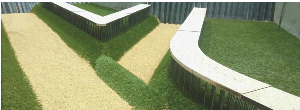
Abbildung 16: Flutmulde im physikalischen Modell (im Beispiel Variante V5 mit Leitdamm)
