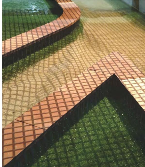
Abbildung 20: Detailaufnahme des Modells im Bereich der Flutmulde mit projizierten Messraster für photogrammetrische Vermessung der Sohle (Quelle: ORLIK)
