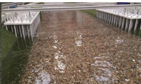
**Abbildung 33: Modellversuch Variante mit lokal begrenzter, beidseitiger Vegetation** (Foto: IWD)
