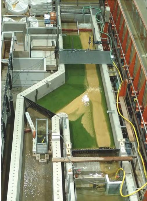
Abbildung 19: Übersichtsdarstellung des Modellversuchs Flutmulde (Quelle: ORLIK)
