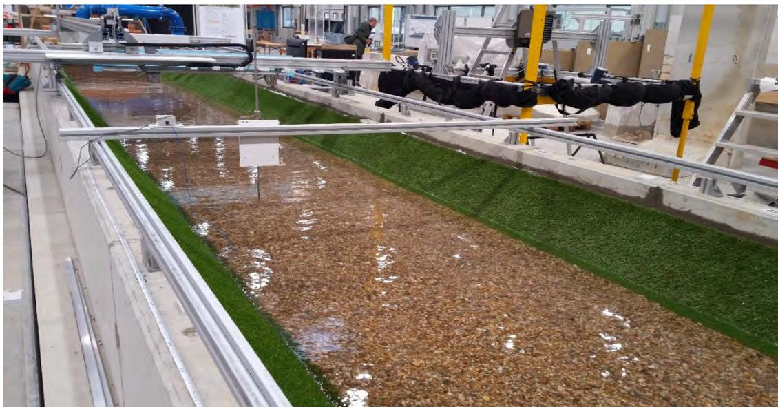
Abbildung 29: Physikalisches Modell zum Einfluss des Böschungsbewuchses auf die Sohlstruktur (Quelle: MIETZ)
