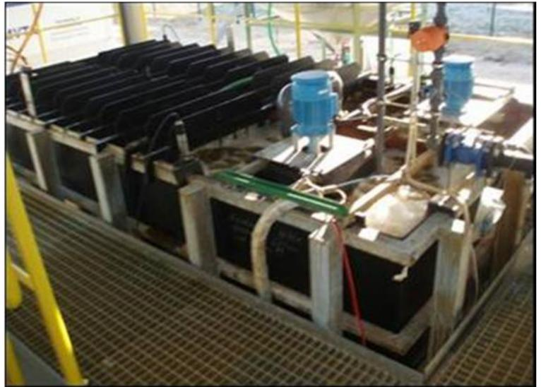
Abbildung 33: Pilotanlage zur EHS Gewinnung (Foto GEOS)
