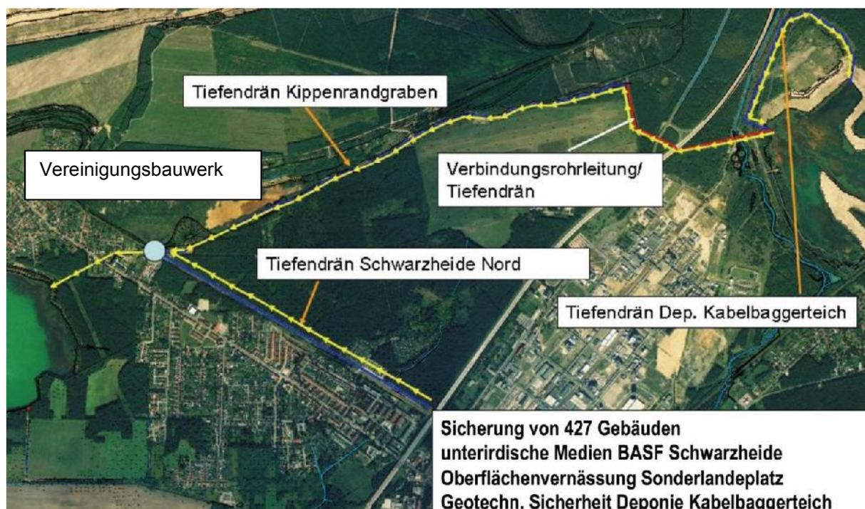
**Abbildung 37: Grundwasserniederhaltung Schwarzheide mit Tiefendrainagen [LMBV 2011]**
