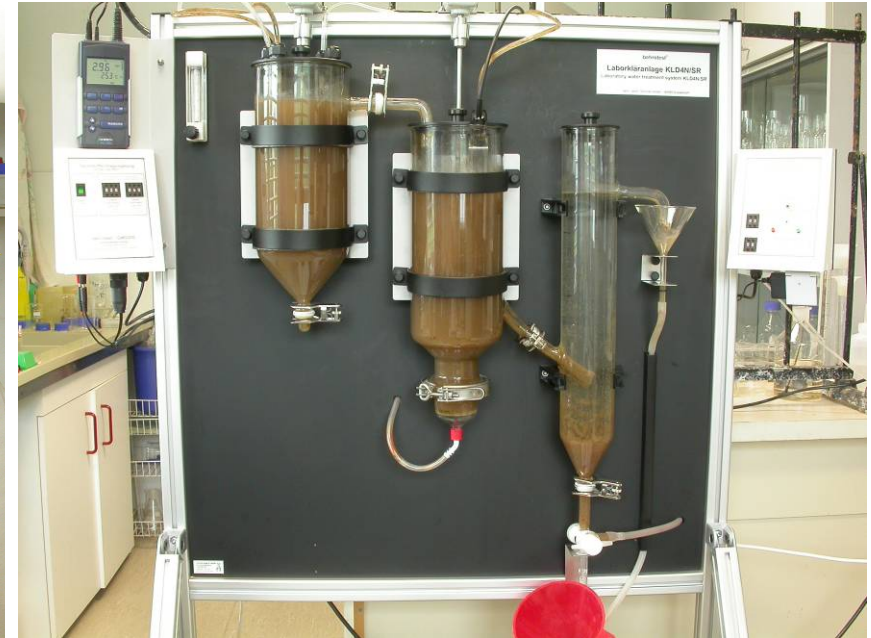
Laborbelebungsanlage mit weitergehender Reinigung (vorgeschaltete Denitrifizierung)
