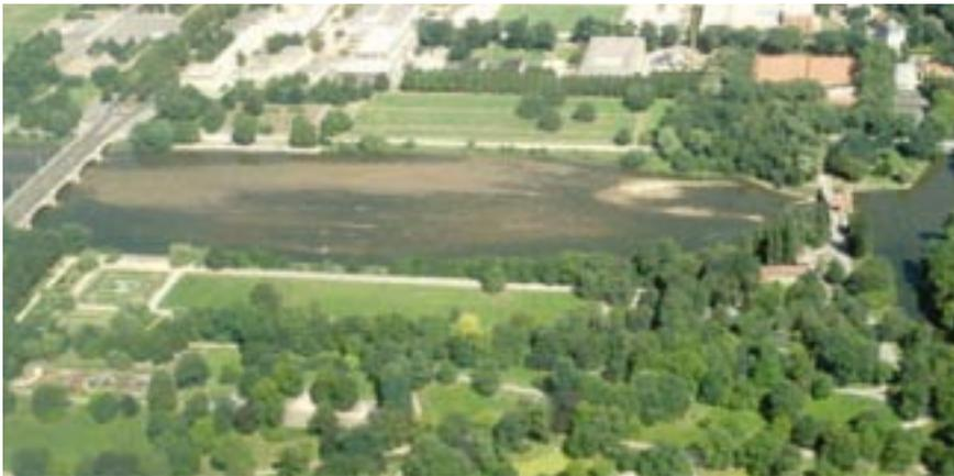
◀ Bild 2: Sedimentablagerungen im Elsterbecken
