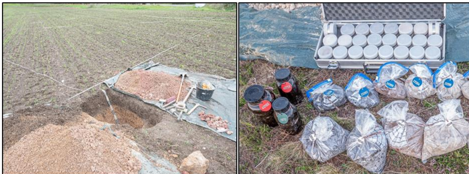
Bodenprobenahme im Schurf (links) und Vorbereitung der Proben für verschiedene Laboranalysen (rechts) (Sinapius 2023)
